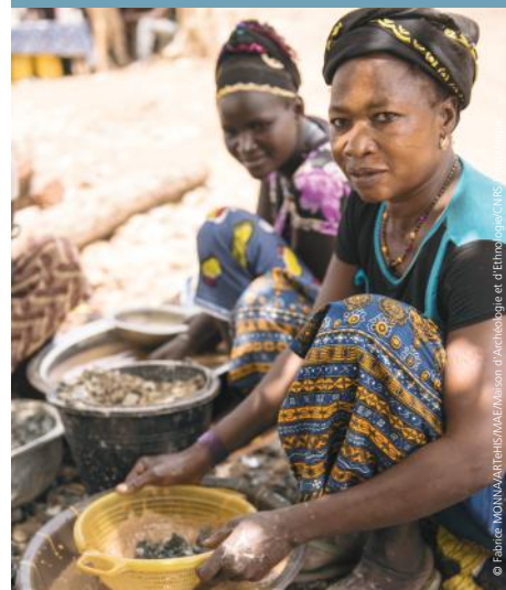
Lavage et triage de minéral concassé, sur une zone d'orpaillage située près du village de Galgouli, au Burkina Faso.
