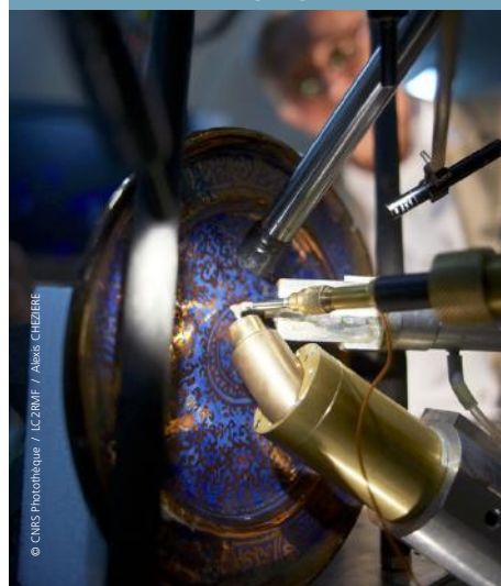
Analyse de la composition du lustre d'une céramique
