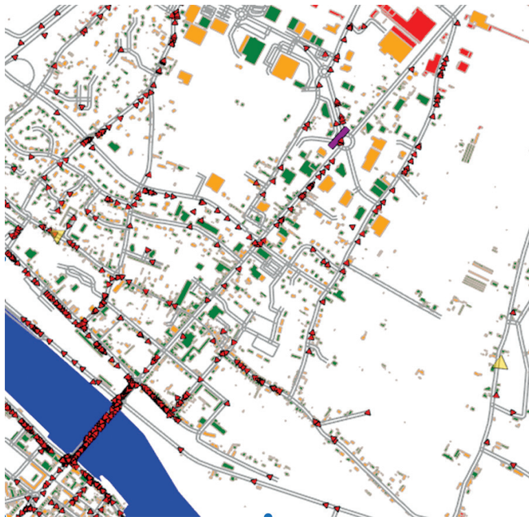
Visuel d'une simulation. Les couches d'informations géographique permettent de représenter les modes d'occupation du sol (bâtiments, routes, fleuve...). Chaque automobiliste (représenté par un triangle rouge) et chaque bus (rectangle violet) sont modélisés par un programme informatique. Des norias de bus sont mises en place pour évacuer les populations non-autonomes. Un agent (triangle jaune à droite) représente une sirène mobile, véhicule surmontée d'une sirène et utilisé pour alerter les populations le long d'un circuit préétabli.
