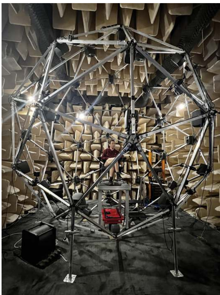
Système de génération de champs sonores tridimensionnels au laboratoire PRISM © Anne HAGUENAUER / PRISM / CNRS Images
