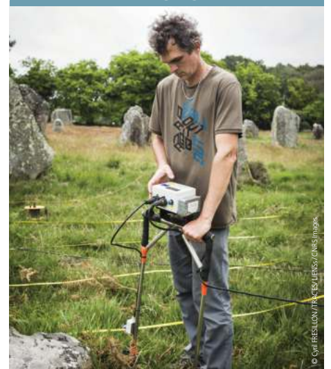
Mesures de résistivité effectuées avec un résistivimètre sur le site mégalithique de Camac, Morbihan
